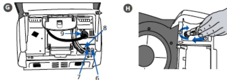
H) Вставьте штекер нагревателя в соответствующий разъем. Закрепите штекер нагревателя, повернув его на 45°.
