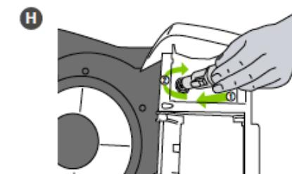
H) Вставьте штекер нагревателя в соответствующий разъем. Закрепите штекер нагревателя, повернув его на 45°.
